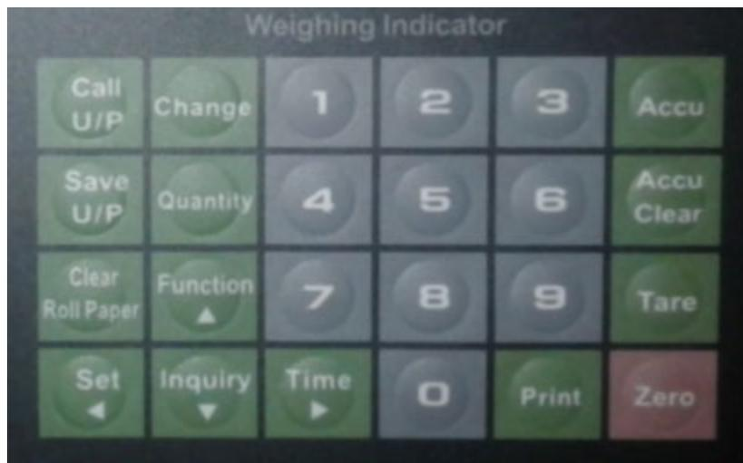
**Цифровые клавиши [0...9]** - В состоянии взвешивания: ввод единичного значения. При настройке параметров: входные параметры.
