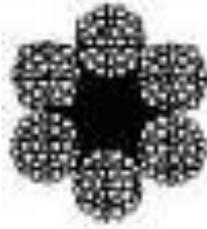
**ГОСТ 3071-88** Производство грузозахватных механизмов. Неответственный подъем.
