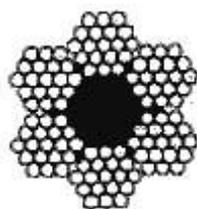
**ГОСТ 2688-80** Канат двойной свивки типа ЛК-Р общего назначения, грузовой и грузолюдской. Изготавливаются марки ВК, В и 1 из проволок без покрытия и из оцинкованной проволоки по группе покрытия С и Ж. Применяется на грузоподъемных машинах и в механизмах различного назначения.
